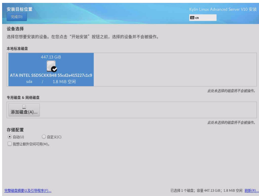
图2-7 勾选用于安装系统的目的硬盘
